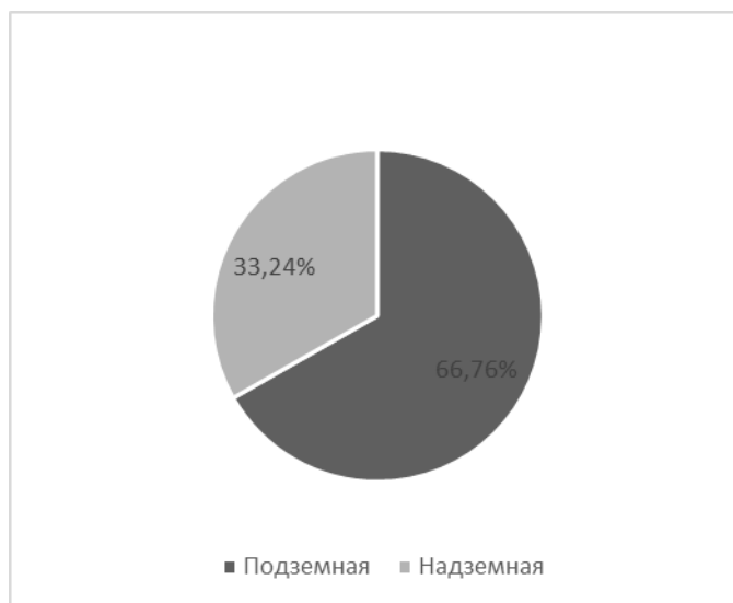
Диаграмма 1. Способы прокладки тепловых сетей
