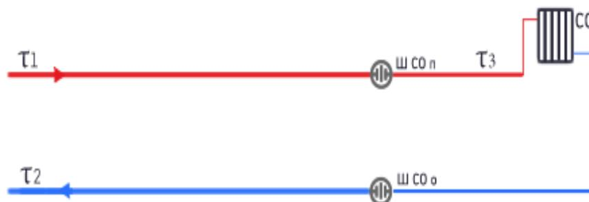
Рисунок 3. Потребитель с непосредственным присоединением СО.
